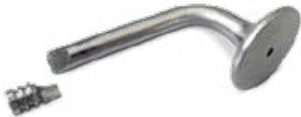
Fig. 1 Ruptura por força excessiva no entalhe
